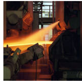
Prozessstabilisierung durch den Einsatz eines Loopers.
